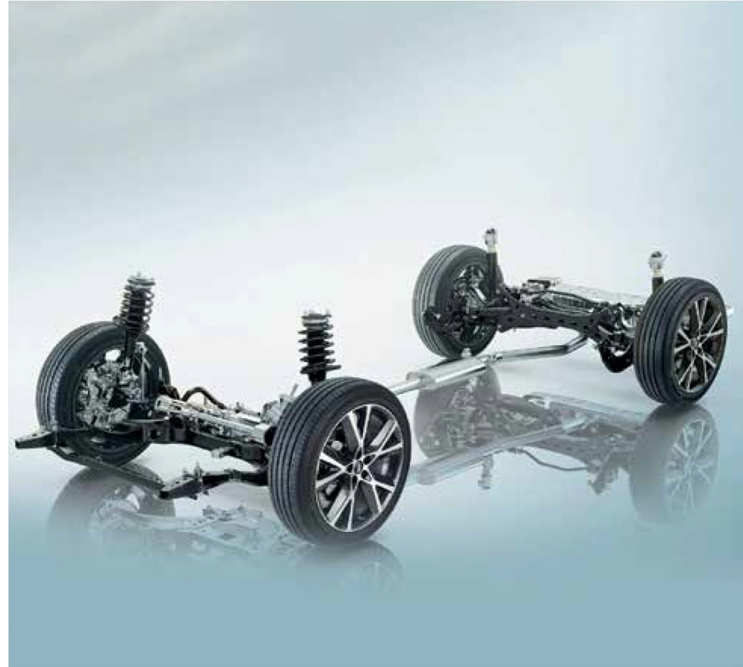
نظام التعليق الأمامي المستقل من McPherson + التعليق الخلفي متعدد الوصلات المستقل McPherson Independent Front Suspension+Independent Multi-link Rear Suspension
